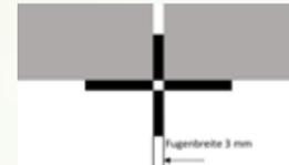
Die Plattenlager haben eine 3 mm Fuge.
