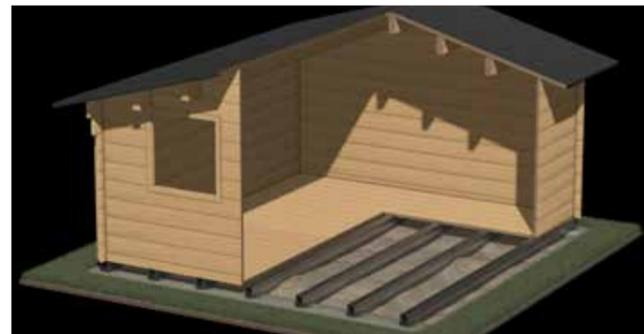
Jumboprofil mit bis zu 4220 mm Überstand zwischen zwei Punktfundamenten bei Auflast von 500 kg/m<sup>2</sup>
