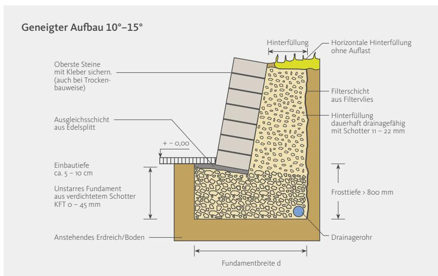
Bis vier Lagen Steine können senkrecht gesetzt werden. Höhere Aufbauten sollten einen Anlauf haben, das heißt, gegen den Hang geneigt sein. Die mögliche Bauhöhe hängt von den örtlichen Gegebenheiten ab. Mit Hilfe von Keilsteinen sind auch geschwungene und gerundete Ausführungen möglich.
