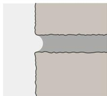
Leicht nach innen gewölbte Fugen harmonisieren unauffällig mit dem Bauwerk und bewirken filigrane Licht- und Schatteneffekte. Sie werden mit einem runden Fugeisen oder kleinen Schlauchstück ausgeführt.
