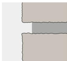
Etwa 1 cm tiefe Fugen rufen auf der Mauer ein besonders intensives Spiel von Licht und Schatten hervor. Sie werden mit einem geraden Fugeisen erzeugt.
