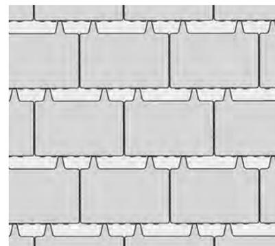
VS 4 Verschiebesicherung
