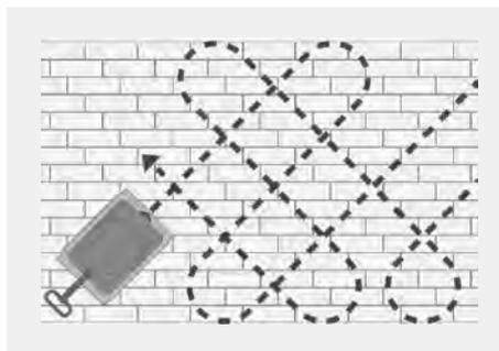
Die Rüttelplatte ist auf die Steindicke abzustimmen. Der erste Rüttelgang dient der Mobilisierung des Fugenmaterials. Anschließend wird nachverfugt und sauber abgekehrt. Die weiteren Rüttelgänge erfolgen in mehreren Übergängen bis zum Erreichen der Ebenheit und der Standfestigkeit des Belags. Zwischen den einzelnen Übergängen ist ggf. wie beschrieben nachzuverfugen.
