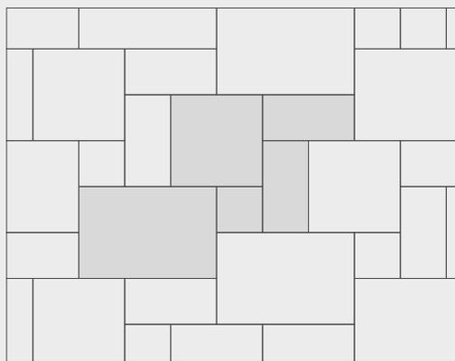
Eine Palettenlage besteht aus fünf Platten in vier verschiedenen Formaten. Daraus wird das Grundmodul für den Römischen Verband gebildet. Durch die einfache Wiederholung des Grundmoduls ist die Fläche beliebig erweiterbar.
