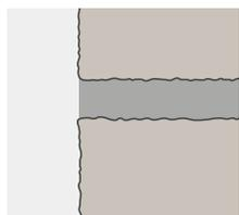
Bündige Fugen betonen die Linienführung der Mauer. Sie werden mit dem geraden Fugeisen abgezogen. Sehr breite Fugen mit einem Pinsel glatt streichen.
